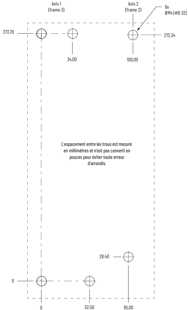
Figure 29 - Gabarit de perçage de la taille 3 à la taille 2
