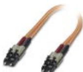
Câble FO équipé, câble Zipcord, fibre de verre multimode 50/125 µm, OM2, connecteurs : LC / LC, indice de protection : IP20, pour goulottes ou armoires électriques
