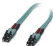
Câble FO équipé, câble Zipcord, fibre de verre multimode 50/125 µm, OM3, connecteurs : LC / LC, indice de protection : IP20, pour goulottes ou armoires électriques
