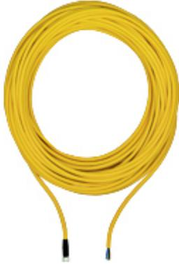
Câble de raccordement, PUR, jaune RAL1003, compatible avec chemin decâbles mobiles, connecteur femelle droit M8 à 4 broches, libre de câblage, codé A, longueur du câble : 10m
