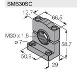
bride de fixation, noir PBT, pour les détecteurs à filetage 30 mm, orientable
