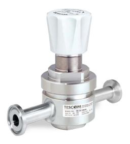
Die TESCOM Serie PHE32 ist Teil unserer Pharmpure-Produktreihe. Die kompakten, einstufigen Ultra-Reinstgasregler für hohe Durchflüsse entsprechen der USP-Klasse VI und BPE. Somit sind sie geeignet für den Einsatz im Biotechnologie- und Pharmabereich für Gasdurchflüsse von 142 bis 1.416 slpm. Die diffusionsdichte rein metallische Dichtung zwischen Membran und Gehäuse gewährleistet Gasreinheit und Dichtigkeit.
