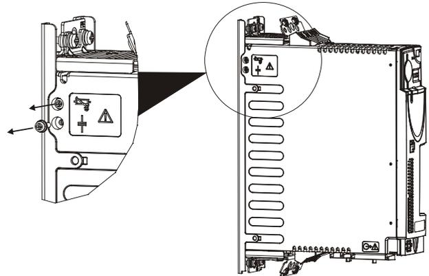
Dévisser la vis supérieure pour déconnecter les écrêteurs de tension, et la vis inférieure pour déconnecter le filtre CEM interne.
