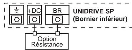
**Nota :** Pour la protection des résistances de freinage extérieures, prévoir un relais thermique.
