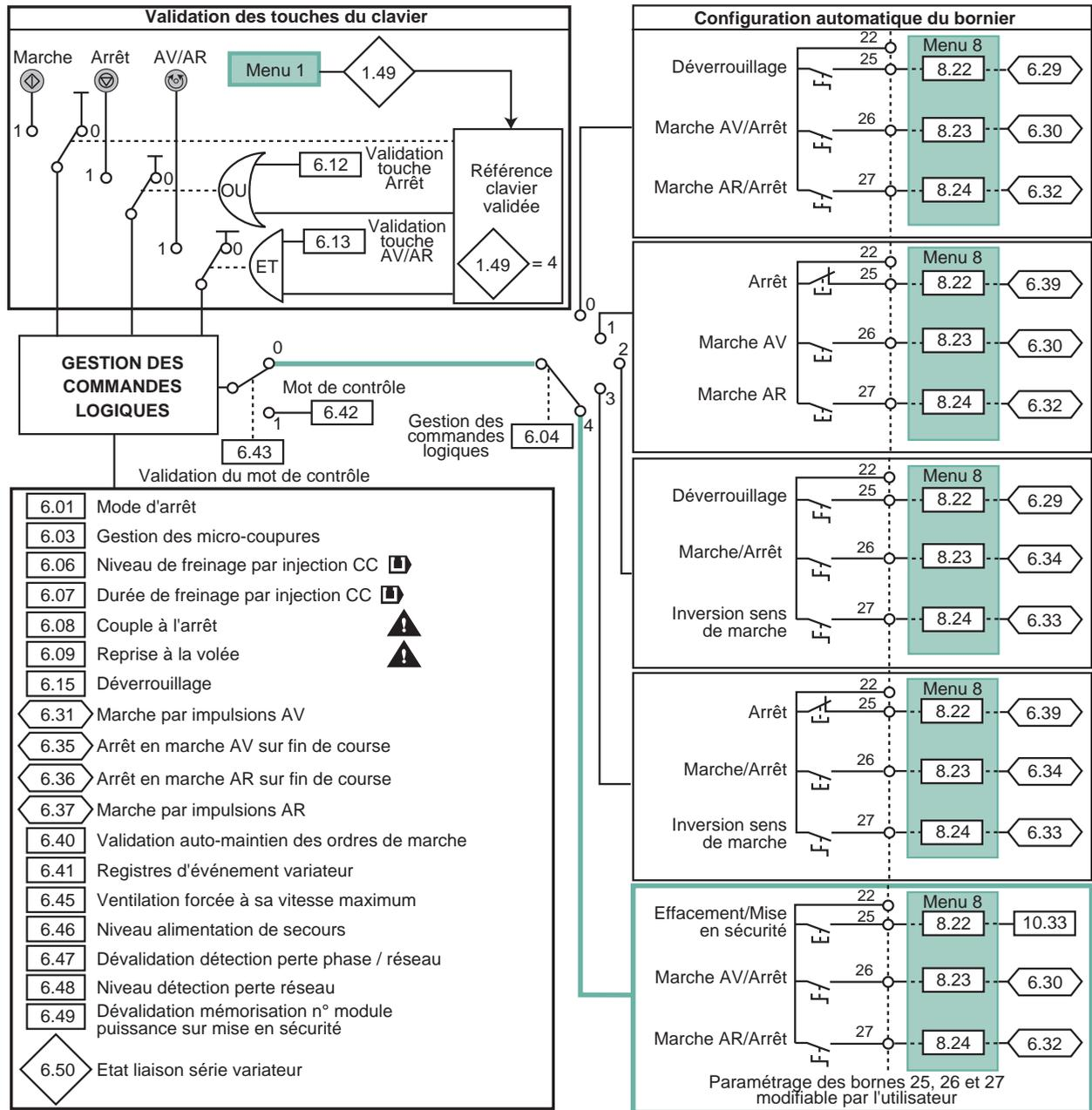
⚠ • Si le couple à l'arrêt est validé, présence de la tension aux bornes du moteur à l'arrêt.
