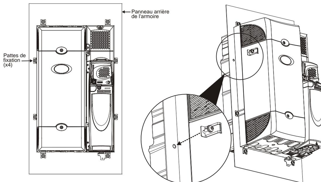
**Nota :** Pour les variateurs tailles 4 et 5, il est nécessaire de plier la patte de mise à la terre en montage encastré. Pour les détails, se reporter à la section D9.4.
