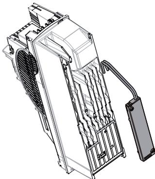
Pour un montage du variateur en surface (radiateur dans l'armoire) :
