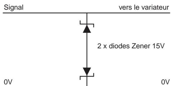
Ces circuits sont disponibles en modules (montage sur rail), par ex. chez Phoenix Contact (unipolaire : TT UKK5 D/24 DC, bipolaire : TT UKK5 D/24 AC).
