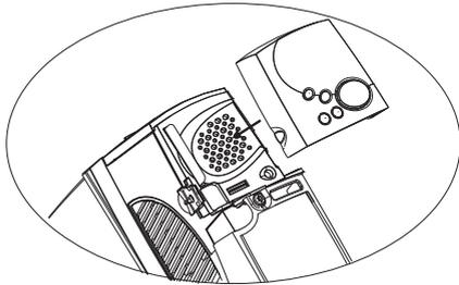
Positionner l'afficheur parallèlement au variateur et appuyer jusqu'à l'obtention d'un clic
