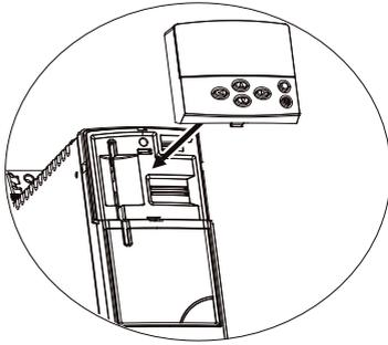
Positionner l'afficheur parallèlement au variateur et appuyer jusqu'à l'obtention d'un clic
