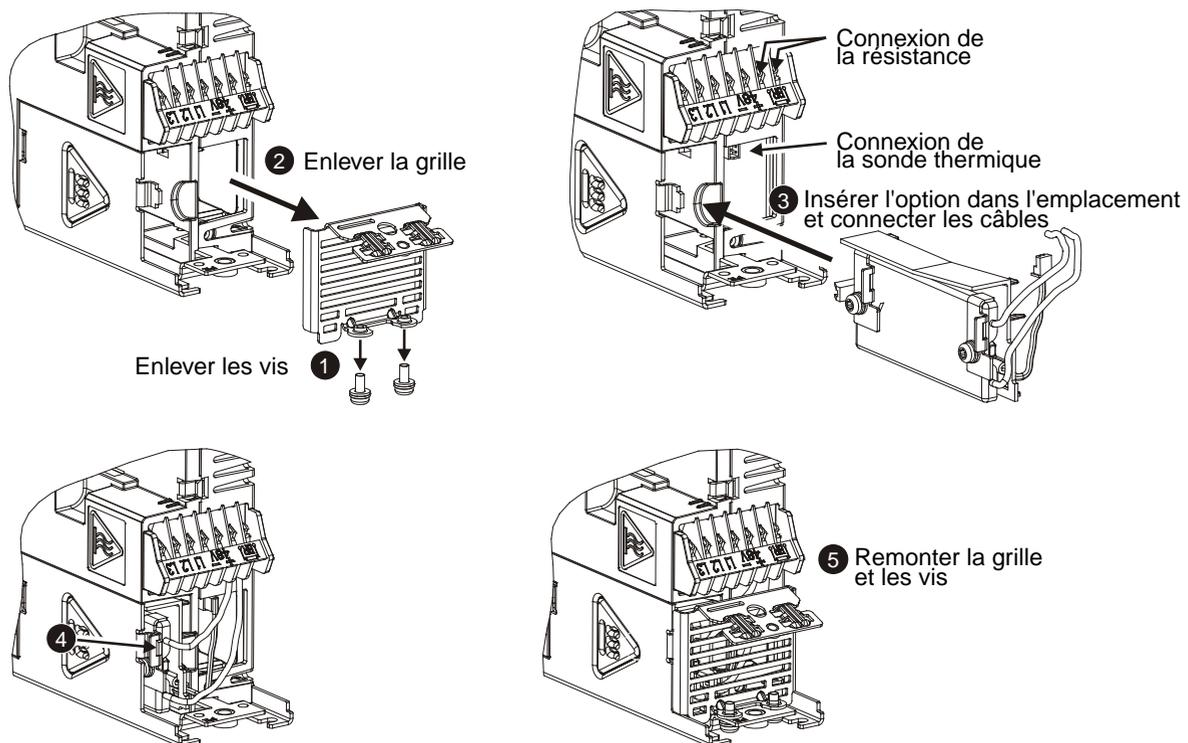
⚠ • La sonde thermique de la résistance intégrable doit être raccordée au variateur.
