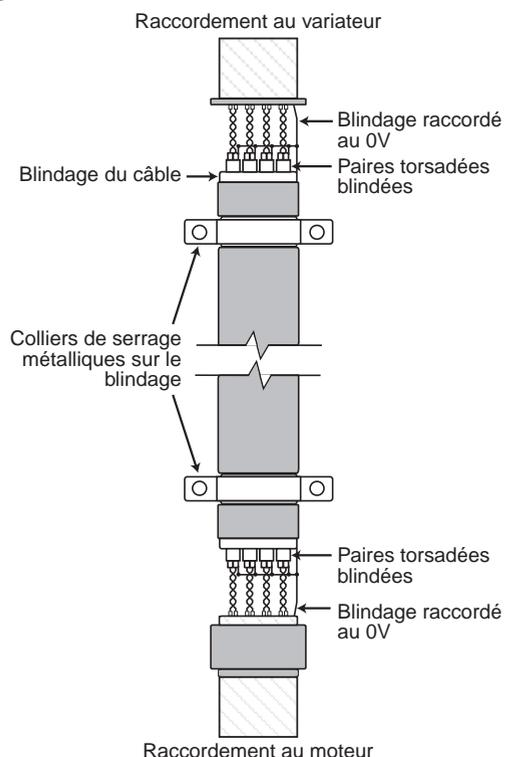
Il est préférable de ne pas faire de reprise sur le câble codeur. Dans le cas où une reprise est inévitable, s'assurer que les raccordements du blindage sont les plus courts possible (utiliser de préférence des colliers de serrage métalliques, directement sur le blindage à l'extrémité du câble ). Raccorder les blindages directement sur le boîtier du codeur et sur le support de blindage du variateur.
