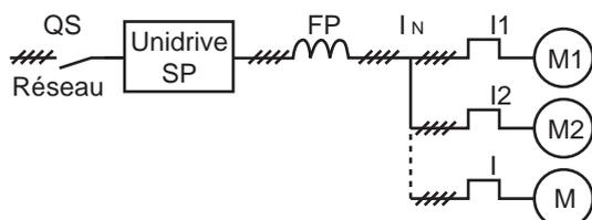
Le mode contrôle du variateur doit être le mode boucle ouverte (**0.48** = Open.LP(1)) avec contrôle U/F (**0.07** = Fd(2) ou SrE(5)).
