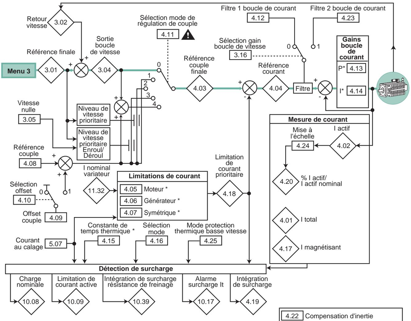
**⚠** • Lorsque le mode commande en couple sans contrôle de la vitesse est validé (4.11 = 1) et sur couple résistant nul, le variateur accélère jusqu'au seuil de survitesse 3.08 (mise en sécurité). Si 3.08 est à 0, la vitesse maximum atteinte sera de  $1.06 + 20\%$ .
