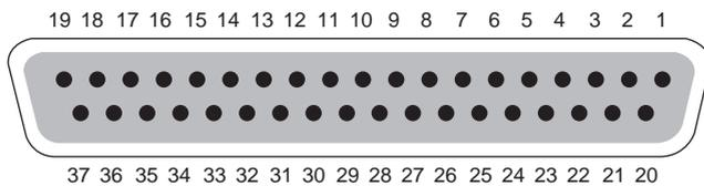
Pour en faciliter le câblage, il existe un boîtier de conversion HD-37 / bornier à vis et un cordon de raccordement entre le module et le boîtier (longueur 1 mètre).
