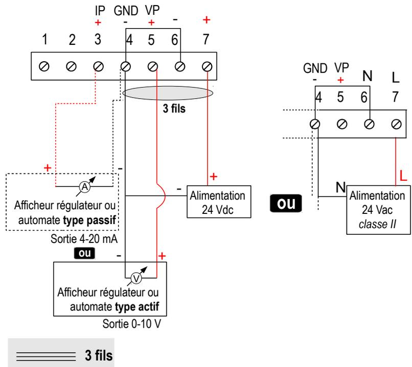
Pour les modèles **CP112/113 – PO** et **CP112/113 – PN** avec sortie 4-20 mA – **passif** :
