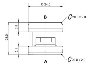
Die angegebenen Maße gelten für den eingebauten Zustand / The dimensions specified apply to the mounted state. Für Bohrungsform CEG-01, CEG-02, CEG-03 und Einschraubhülse ESH For cavity CEG-01, CEG-02, CEG-03 and threaded mounting sleeve ESH
