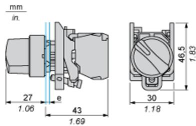
e : épaisseur du dispositif de serrage : 1 à 6 mm / 0,04 à 0,24 pouce
