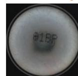
La surface incurvée est éclairée de manière uniforme et l'impression peut être détectée.
