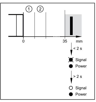
Si le détecteur est désamorti pendant plus de 2 s (> 35 mm), l'aide au réglage est désactivée et la LED de signal jaune s'éteint.
