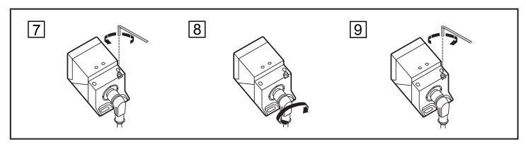
➤ Serrer le connecteur femelle selon les indications du fabricant. Prendre en compte le couple de serrage pour le connecteur femelle ifm (p.ex. EVxxxx : 0,6...1,5 Nm).
