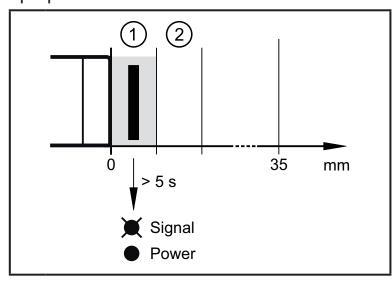
L'aide au réglage est activée en posant un objet métallique devant le détecteur de sécurité (zone rapprochée).
