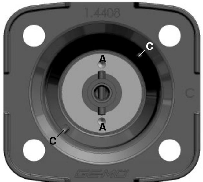
Ist die Antriebsspinde nicht in der richtigen Position, muss sie in die richtige Position gedreht werden. Die Position von **A** ist gegenüber der Position von **C** um 45° versetzt.
