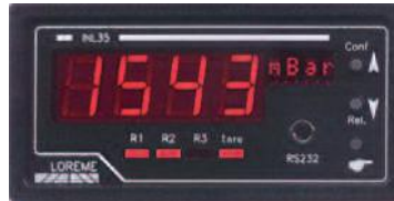
Profondeur : 84 mm, masse 0,18 kg, encastrable dans une découpe 92,5 x 42,5 mm
