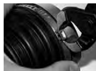
Étape 4 Positionner le collier sur la pièce. Engager les crochets dans les fenêtres d'accrochage les plus justes. Serrer fermement la base de l'oreille à l'aide d'une pince Oetiker.
