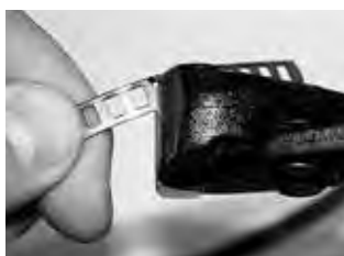
Étape 3 Couper la longueur excessive. Pour éviter toutes blessures, ébavurer les bords avec une lime.
