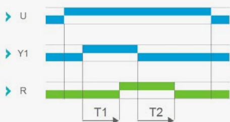
Fonction Ad : Enclenchement retardé par commande (pas resetable)
