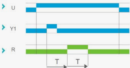
Fonction At : Relais temporisé à addition de temps
