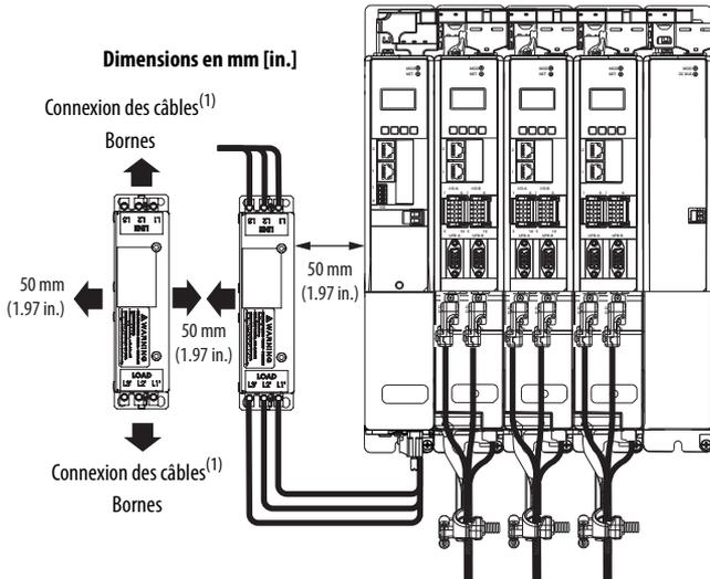
(1) Le dégagement des bornes tel que requis pour le rayon de courbure spécifié en conformité avec le NEC dépend de la section des câbles utilisés.
