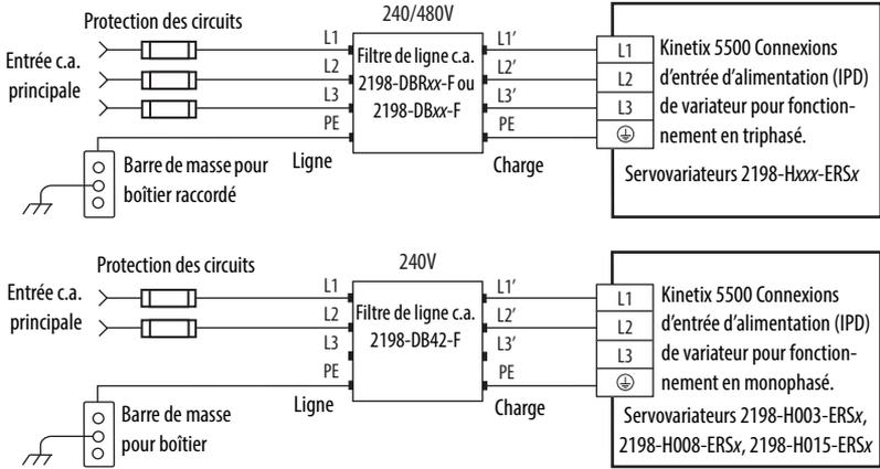
**Exemples de câblage de filtre de ligne c.a. (variateurs Kinetix 5700)**
