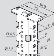
Pattes de fixation pour châssis et barreau de terre
