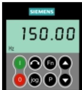
Le panneau de commande basique (BOP) donne accès aux paramètres du variateur et permet à l'utilisateur de personnaliser les réglages du MICROMASTER 440. Le BOP peut servir à configurer plusieurs variateurs MICROMASTER 440. Dans ce cas, le BOP est utilisé pour définir les paramètres voulus et peut être remplacé par le SDP une fois l'opération achevée.
