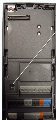
Interrupteur DIP de régl. analogique
