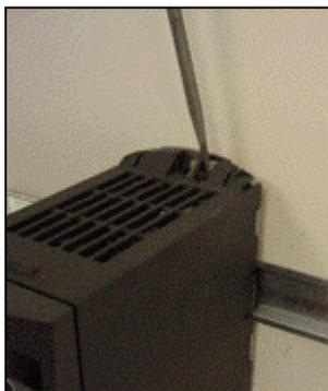
1. Pour désengager le mécanisme d'encliquetage du variateur, glissez-y un tournevis.
