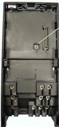
Interrupteur DIP pour fréq. réseau
