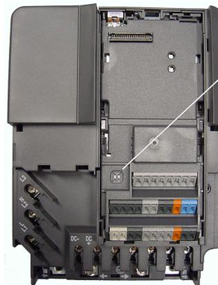
Interrupteur DIP de régl. analogique
