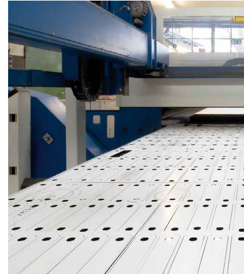
Trumpf; Stahldicken bis 25 mm, mit vollautomatischen Plattenlagern Trumpf; steel thickness up to 25 mm, with fully automatic pallet stock Trumpf; épaisseur d'acier 25mm, avec magasin des palettes entièrement automatique
