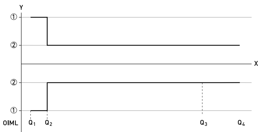
Figure 6-2: Débits ISO ajoutés au schéma pour comparaison avec OIML
