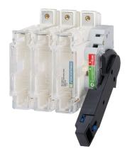
Les FUSERBLOC à commande directe sont des interrupteurs-sectionneurs fusibles multipolaires à commande manuelle. Ce mécanisme de commande est adapté pour la manoeuvre de l'appareil à l'intérieur d'une enveloppe. Ils assurent la coupure ou la fermeture en charge, le sectionnement de sécurité et la protection contre les surintensités de tout circuit électrique basse tension. Cette gamme se décline en commande directe, en 2, 3 et 4 pôles et de 25 à 400A.
