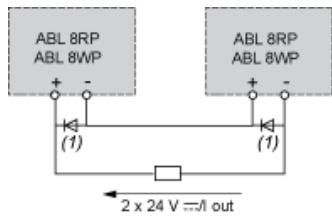
(1) 2 Schottky-Dioden  $I_{min} = I_n$  in der Spannungsversorgung und  $V_{min} = 50$  V.
