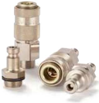
Kupplungssystem mit deutschem Industrieprofil. Kupplungssystem mit Einhandbedienung. High Flow Ventil für optimale Durchflussleistung und geringen Druckabfall. Robuste Kupplung in schlanker Bauweise für hauptsächlich pneumatische Anwendungen. Die Entriegelungshülse aus Stahl wirkt oszillierenden Kräften entgegen. Die hohe Eintauchtiefe garantiert eine optimierte Stecknippelführung.
