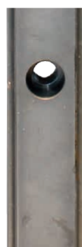
Rail (non chargé) avec revêtement CTS – après 22 heures de test de brouillard salin (selon DIN ISO 9227)
