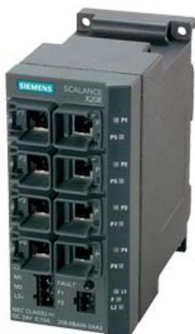
SCALANCE X208, managed IE Switch, 8 ports 10/100 Mbit/s ports RJ45, diagnostic LED, contact de signalisation de défaut avec bouton-poussoir Set, alimentation alimentation, PROFINET IO, gestion de réseau, gestionnaire de redondance intégré, avec manuel électronique sur CD-ROM, C-PLUG en option.
