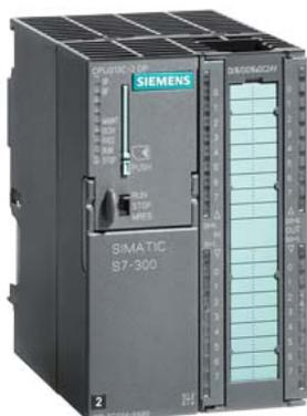
SIMATIC S7-300, CPU 313C-2 DP CPU compacte avec MPI, 16 entrées TOR/16 sorties TOR, 3 compteurs rapides (30 kHz), interface DP intégrée, alimentation intégr. 24V CC, 128 Ko de mémoire de travail, connecteur frontal (1x 40 pôles) et microcarte mémoire requise
