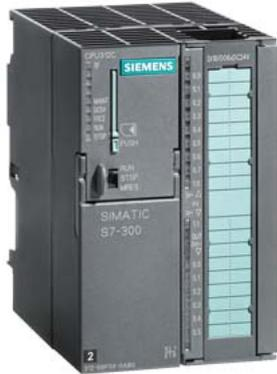
SIMATIC S7-300, CPU 312C CPU compacte avec MPI, 10 entrées TOR/6 sorties TOR, 2 compteurs rapides (10 kHz) alimentation intégr. 24V CC, 64 Ko de mémoire de travail, connecteur frontal (1x 40 pôles) et microcarte mémoire requise
