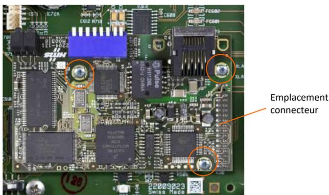
**Figure 3-60 : Module d'interface d'automate programmable installé sur la carte principale**
