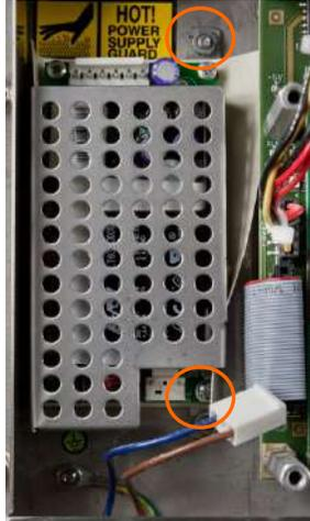
**Figure 3-59 : Alimentation électrique, déconnectée**
