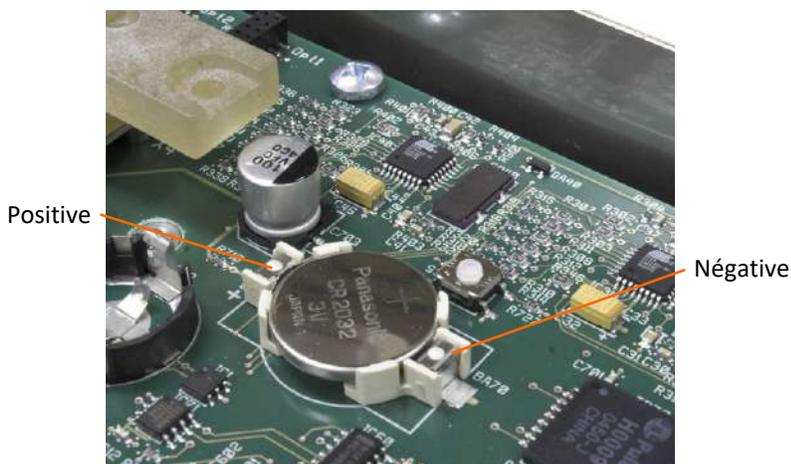
Figure 3-12 : Batterie installée
