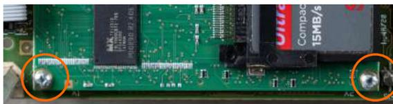
**Figure 3-52 : Vis de fixation de la carte ETC**
