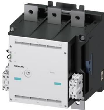
contacteur sous vide CA-3e 630 A, 335 kW / 400 V, 3 CA 820 A, 450 kW / 400 V, Ue 690 V, 3 pôles, Uc : 380-460 V CA(50/60 Hz) entraînement : conventionnel contacts auxiliaires 4 NO + 4 NF courant principal : barre circuit de commande et de courant auxiliaire : borne à vis
