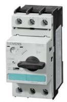
Disjoncteur de taille S0 pour la protection des moteurs CLASS 10, Déclencheur de surcharge à temps dépendant 4,5...6,3 A Déclencheur de court-circuit 82 A borne à vis pouvoir de coupure standard !!! Produit en fin de vie !! Le successeur est SIRIUS 3RV2 Successeur préféré : >>3RV2011-1GA10<<
