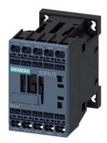
contacteur de puissance, AC-3e/AC-3, 9 A, 4 kW / 400 V, 3 pôles, 24 V DC, 0,7-1,25\* US, avec diode intégrée, contacts auxiliaires : 1 NO, borne à ressort, taille : S00, convient pour sorties API, non extensible avec bloc de contacts auxiliaire
