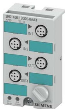
Module compact K45 AS-i TOR 2DI/2DQ, IP67 2 x entrées, 200 mA max. 2 x sorties, 2 A 24V CC 3 A max. pour toutes les sorties 4 x connecteurs femelle M12
