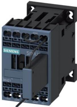
contacteur auxiliaire ferroviaire, 2 NO + 1 NF, 125 V DC, 0,7-1,25\*Us, avec intégration d'une diode de suppression, borne à ressort, taille S00, fixation sur rail DIN optimisé pour le transport (20 G)
