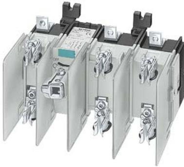
Interrupteur-sectionneur à fusibles nouveau design Iu=125A, Ue=690V, 3 pôles pour fusible à couteaux NH, taille 00 Version de base sans manivelle ni arbre 8UC6
